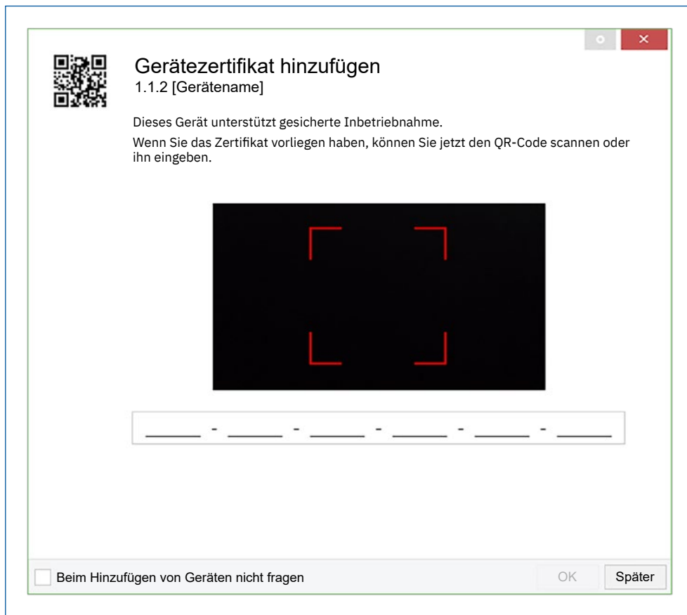
Abbildung 4: Inbetriebnahme mit ETS – Sicherheit: Gerätezertifikat hinzufügen
