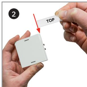
2 Hebelwerkzeug von oben, bis zur ersten Arretierung zwischen Wippe und Taster-Unterteil einführen. „TOP“ zeigt dabei lesbar nach vorne.
